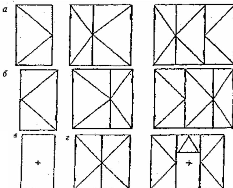
а — оконные блоки левого открывания; б — оконные блоки правого открывания; в — неоткрывающийся оконный блок; з — оконные блоки симметричного открывания
