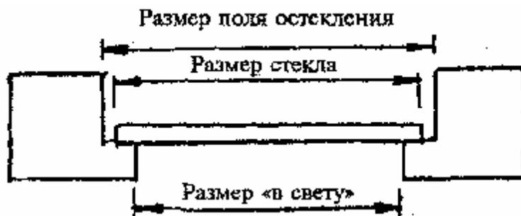
Рисунок А.1 — Определение размеров светопрозрачного заполнения
