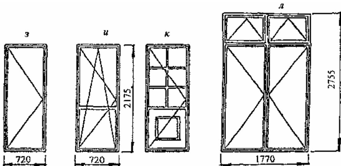
*а, б, в, г, д, е, ж* — примеры конструкций оконных блоков 15М по высоте; *з, и* — конструкция однодольных балконных дверных блоков размером 22-7; *к* — то же, по индивидуальному заказу: с горбыльковым переплетом и глухой филёнкой; *л* — примеры конструкции двупольного балконного дверного блока с двойной фрамугой для общественных зданий размером, 28-18
