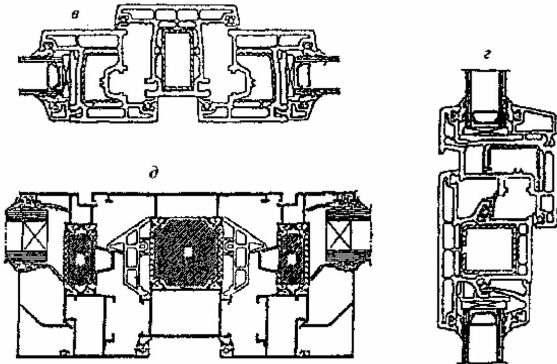
*а* — вертикальные безимпостный (штульповый) и импостный притворы деревянного оконного блока; *б* — горизонтальный импостный притвор деревянного оконного блока; *в* — импостный притвор оконного блока из ПВХ профилей; *г* — узел импостного соединения открывающейся створки и остекленной коробки; *д* — импостный притвор оконного блока из алюминиевого сплава
