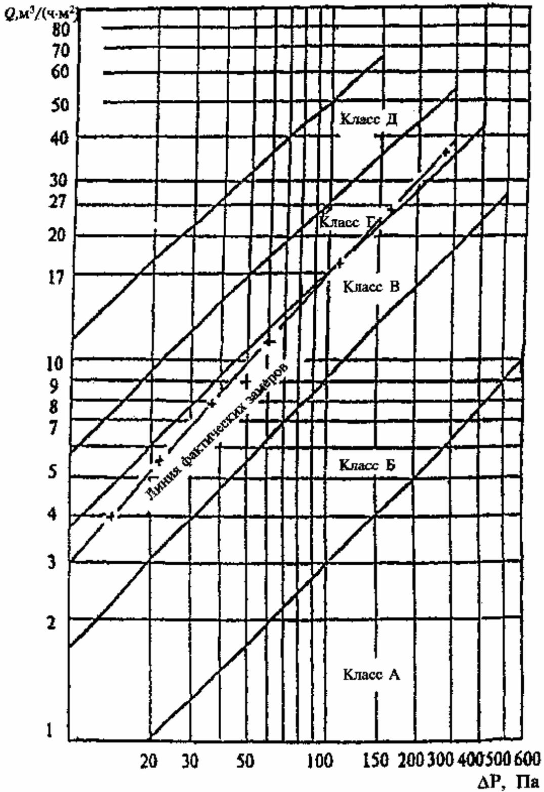
Рисунок Б.1 — Пример определения класса воздухопроницаемости
