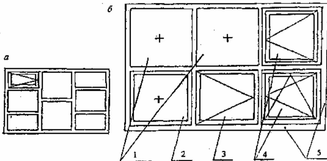
*a* — пример деревянной оконной рамы для остекления веранды; *б* — пример металлической рамы с различными видами заполнения конструкции: 1 — стеклопакетами; 2 — неоткрывающейся створкой (или остекленной коробкой); 3 — открывающейся (распашной) створкой; 4 — оконными блоками; 5 — рама
