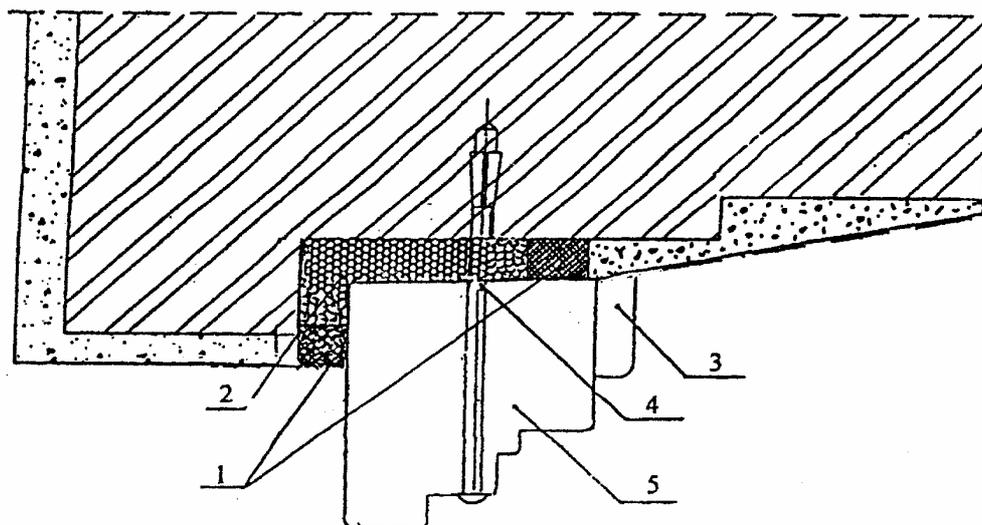
1 — уплотняющие прокладки (снаружи — водонепроницаемые, изнутри — паронепроницаемые); 2 — пеноутеплитель; 3 — деревянный нащельник; 4 — строительный дюбель; 5 — брусок оконной коробки
