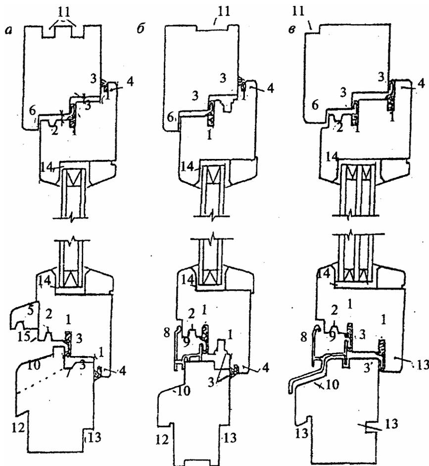
а — конструкция оконного блока с однокамерным стеклопакетом, деревянным отливом и притвором под ввертные петли; б — конструкция оконного блока с однокамерным стеклопакетом, алюминиевым отливом и притвором под поворотно-откидное устройство; в — конструкция оконного блока с двухкамерным стеклопакетом, алюминиевым отливом и притвором под ввертные петли
