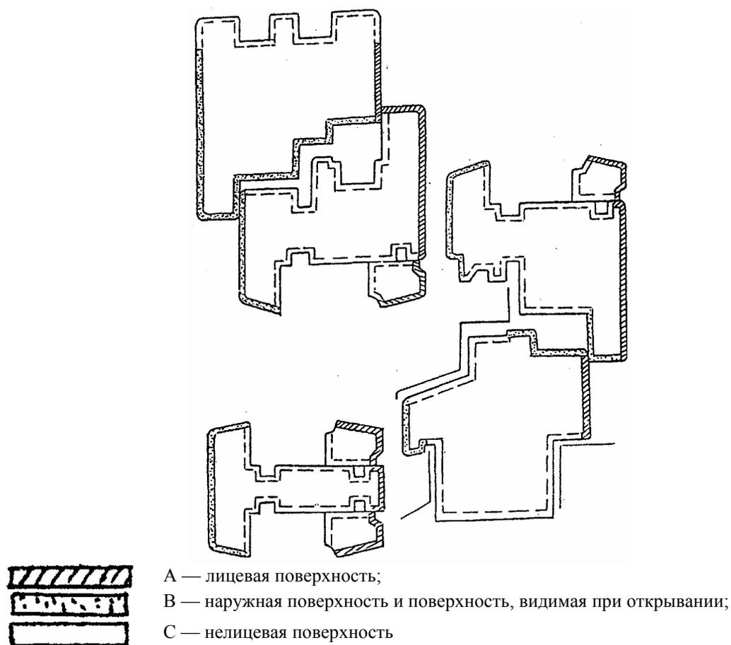
Рисунок 4 — Примеры определения видов поверхностей деталей
