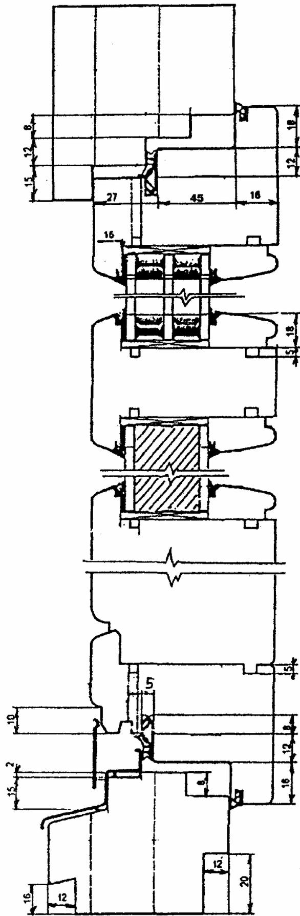
Рисунок 2 — Пример конструктивного решения балконного дверного блока
