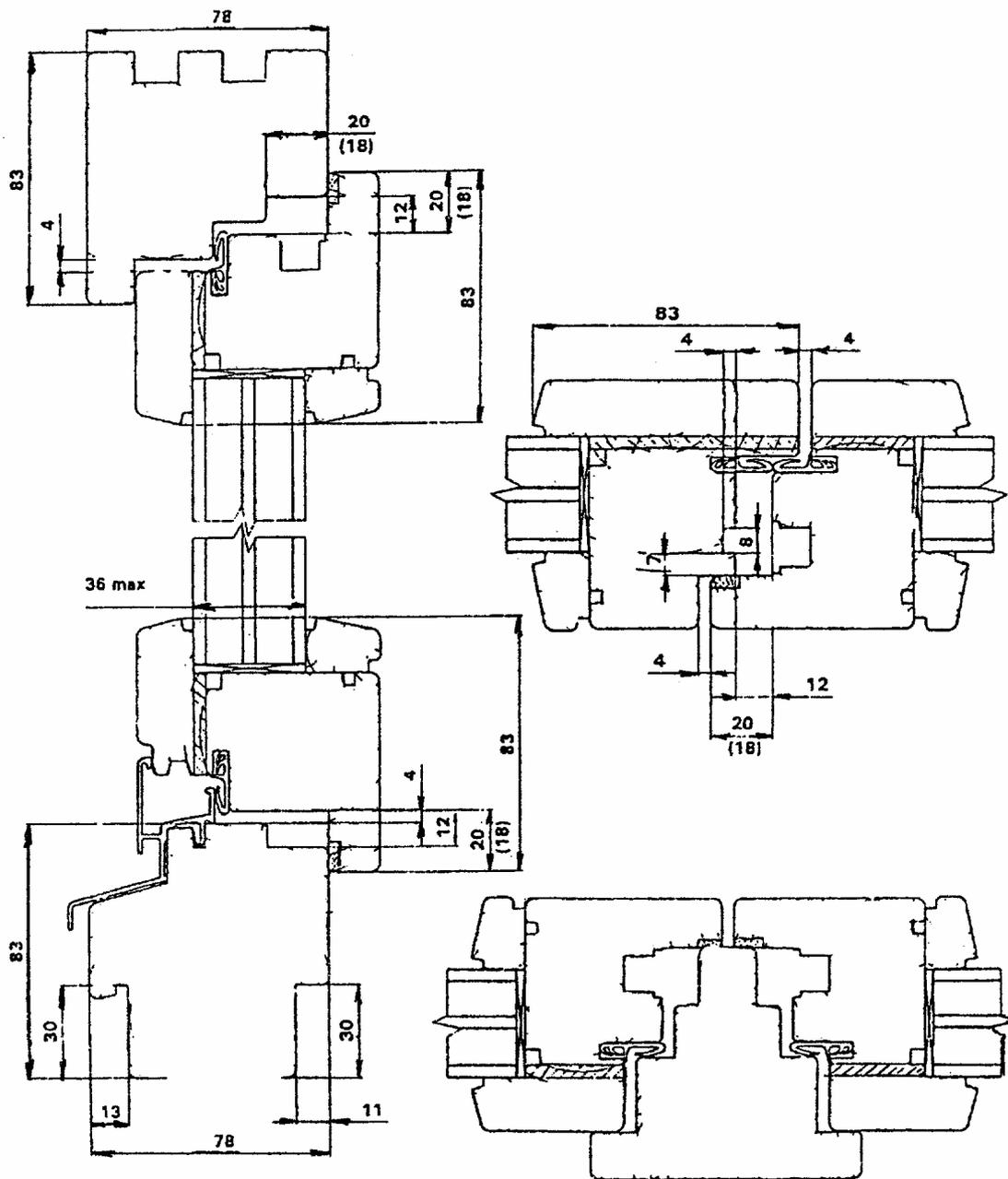
Рисунок 1 — Пример конструктивного решения оконного блока
