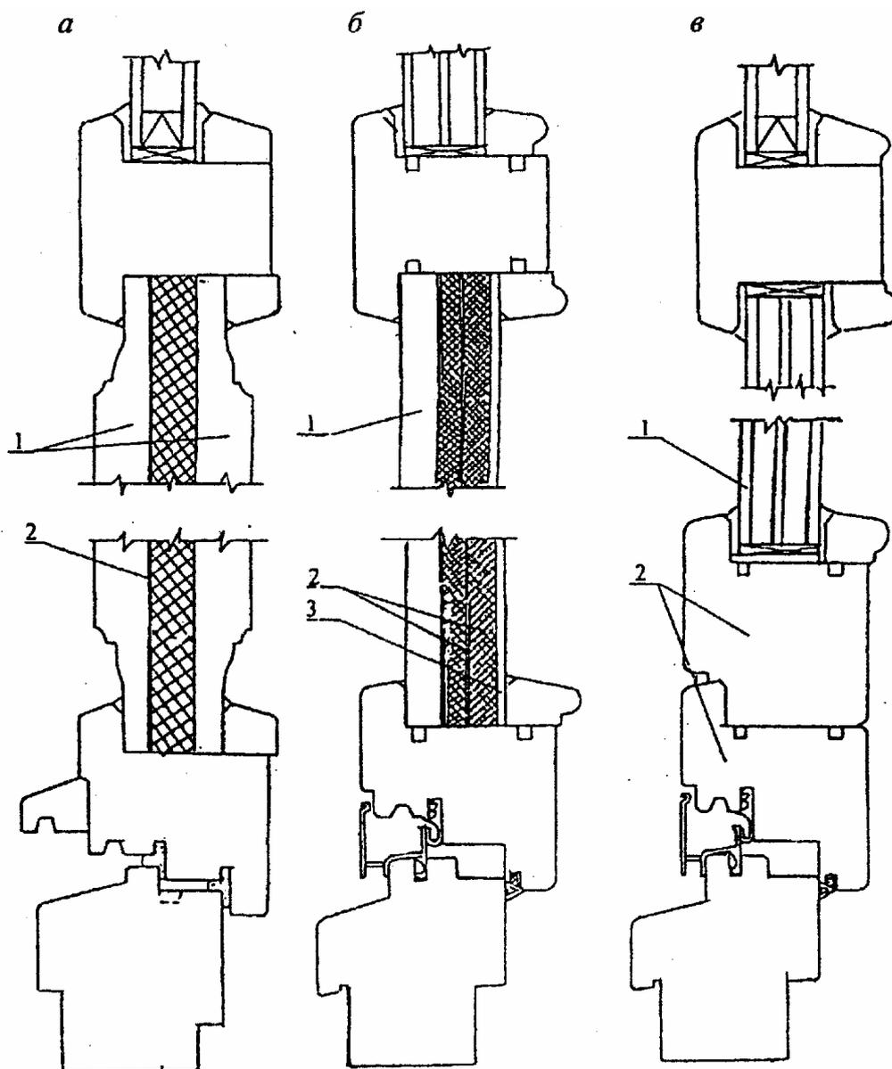
*a* — фигурейная филенка: 1 — деревянные полуфиленки; 2 — теплоизоляционный материал;
