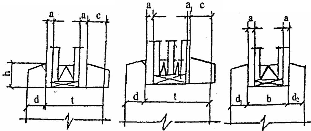
$t$  — размер основания фальца (четверти под остекление);  $d$  ( $d_1$ ,  $d_2$ ),  $h$  — размеры боковой щечки опоры остекления;  $c$  — размеры опоры для крепления штапика;  $a$ ,  $a_1$  — толщина внутренних слоев герметика;  $b$  — размер паза под стеклопакет
