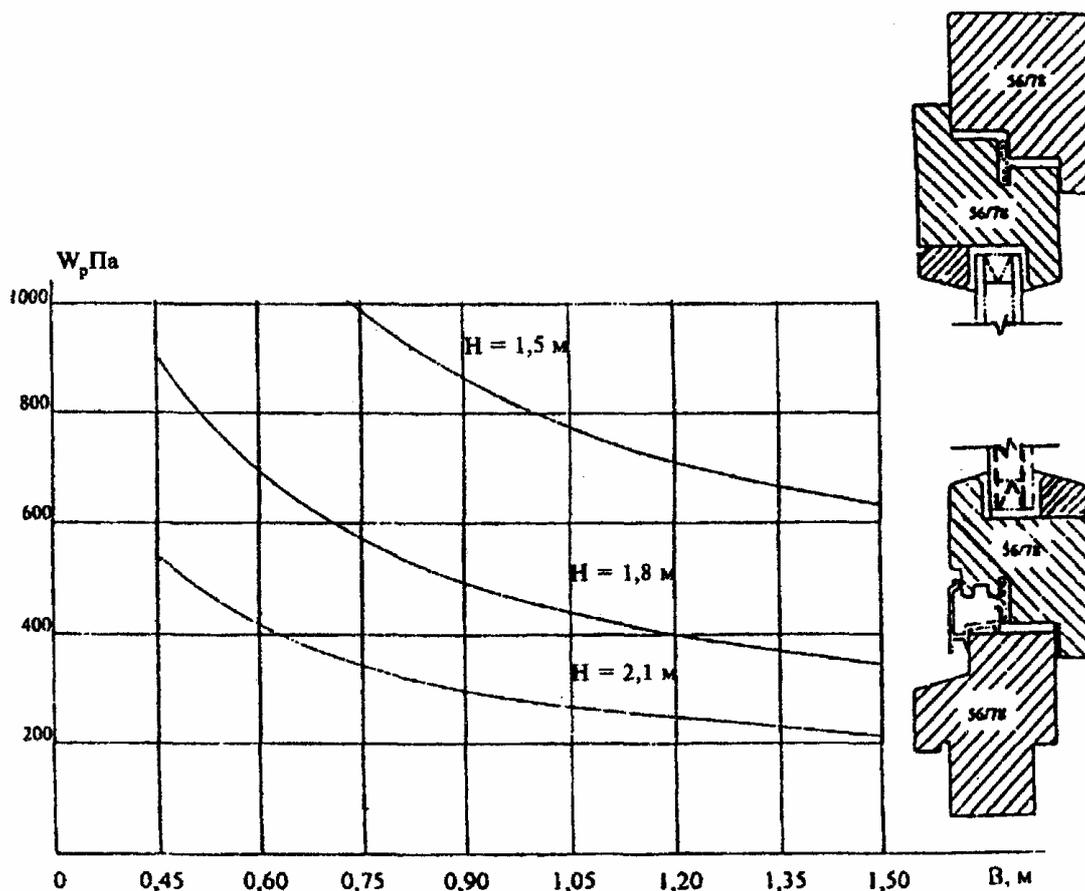
**Рисунок Б.1** — Пример графического определения соотношения высоты  $H$  и ширины  $B$  створчатых элементов с сечением брусков 56 x 78 мм в случае воздействия ветровой нагрузки  $W_p$  (для распашного и поворотно-откидного открывания, масса стеклопакета — не более 50 кг)
