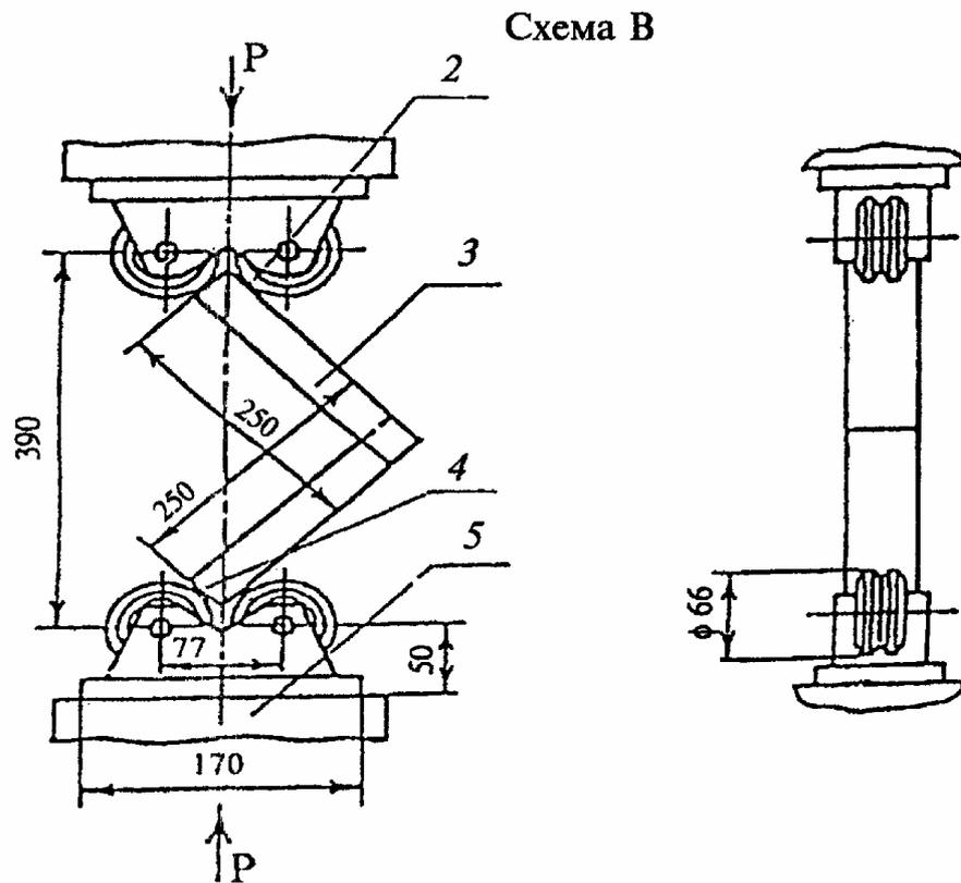
1 — съемные хомуты крепления; 2 — точка приложения нагрузки; 3 — образец; 4 — упор (для схемы В — ролики); 5 — опора
