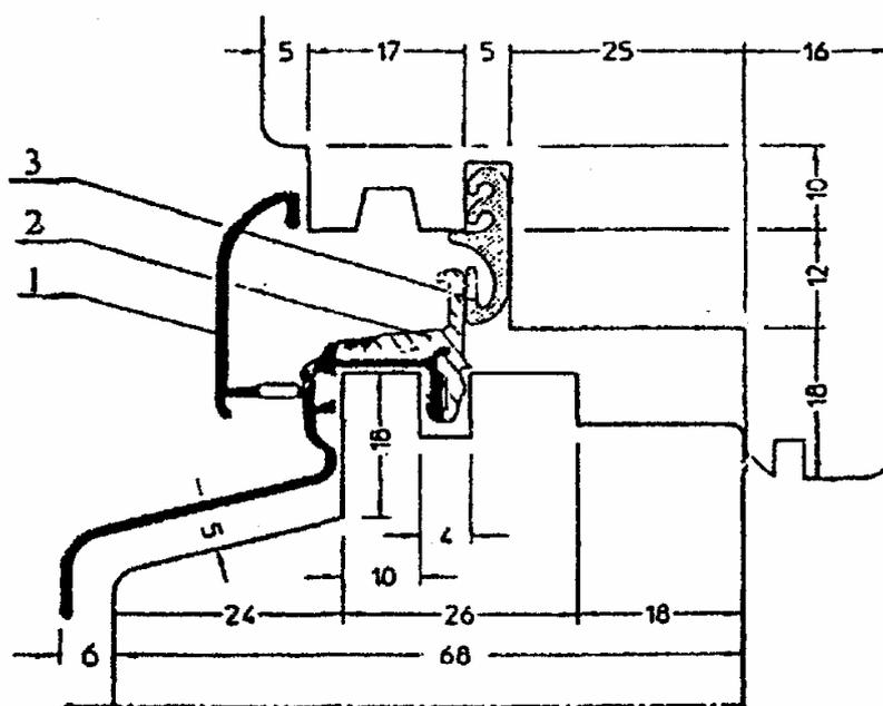
1 — алюминиевый отлив; 2 — термовкладыш; 3 — уплотняющая прокладка и конструкция алюминиевого дождеотводящего профиля (отлива) с терморазрывом
